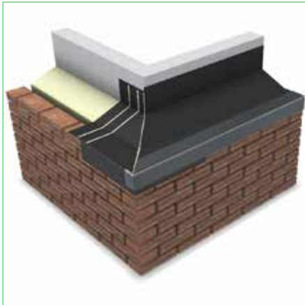
Aanbrengen drie rillen Hechtkit 2000 volgens tekening
