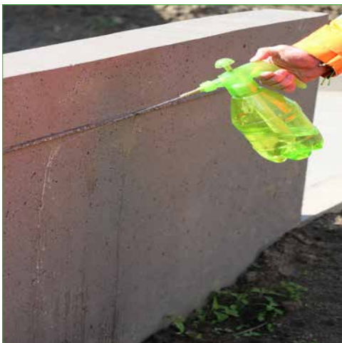
Water gespoot op met CPC NeverWeather behandelde betonmuur: druppels zichtbaar
